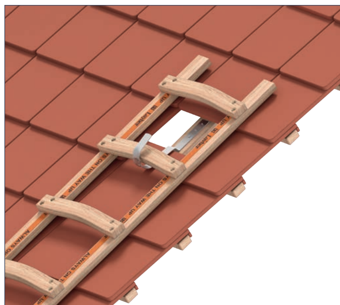
Beispielhafte Anwendung des Sicherheitshakens Modell Z (Pos. 1)
